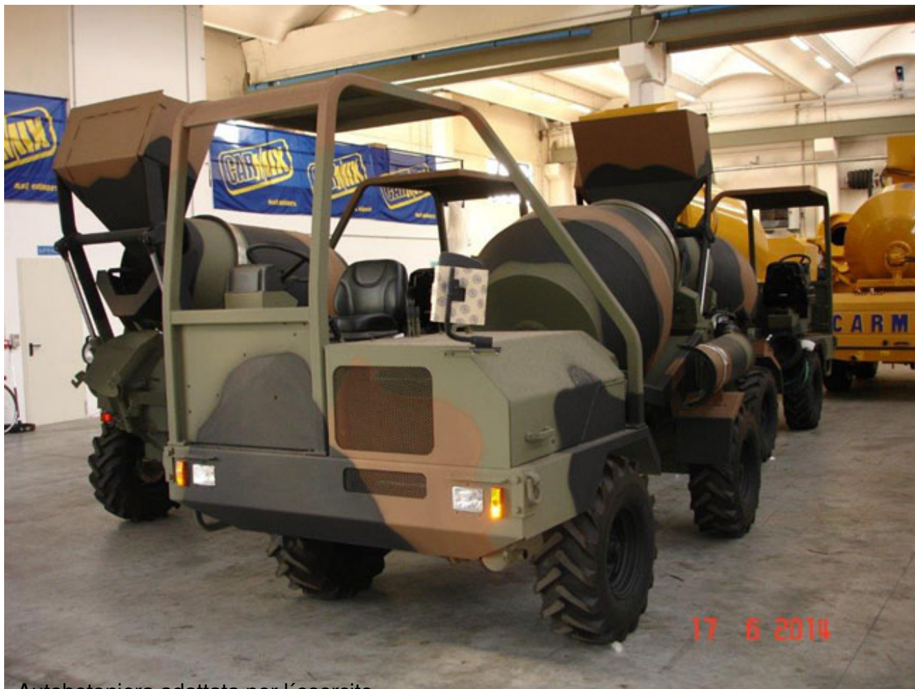
Autobetoniera adattata per l'esercito
